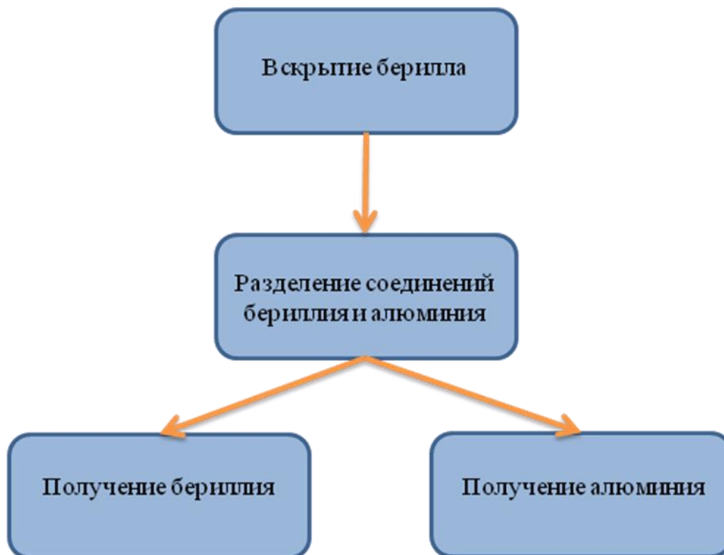
Рис. 3.1. Основные стадии переработки берилла.
