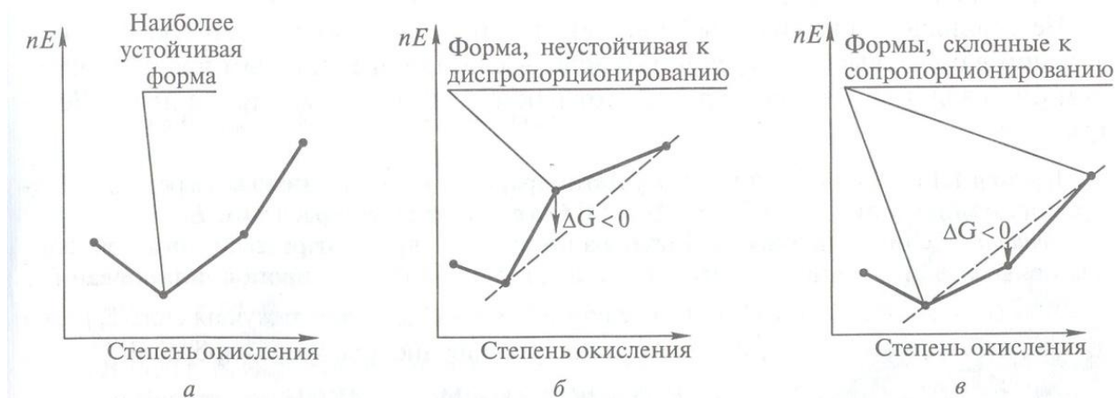
Рис.2 Схемы диаграмм Фроста, иллюстрирующие наиболее стабильные окислительные формы (а), склонные к реакции диспропорционирования (б), и формы, склонные к реакциям сопропорционирования (в)
